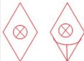
Установка водяного пожаротушения
