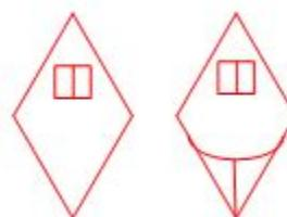
Установка порошкового пожаротушения
