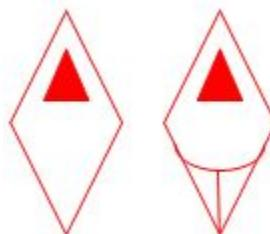
Станция пожаротушения прочим газом
