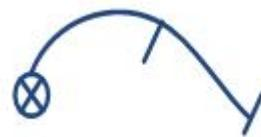
Подъемник пенный с гребенкой генераторов ГПС-600
