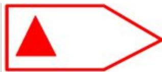
Автомобиль газоводяного тушения
