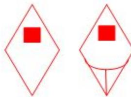
Установка парового пожаротушения
